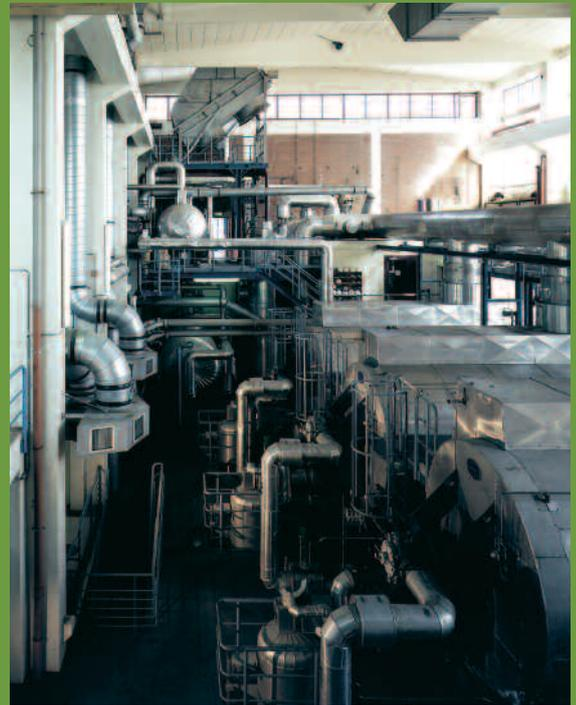
Klärschlamm-trocknung mit Scheibentrocknern
