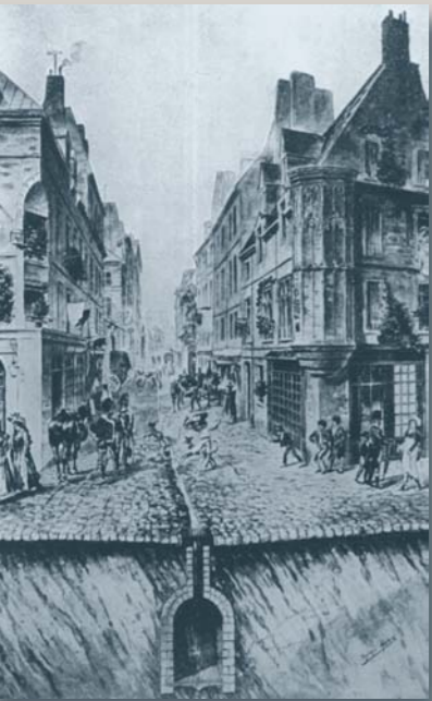
1830 Die Vorläufer der heutigen Kanalisation: Abflusrinne in der Mitte der geneigten Straße, Straßeneinlauf und Kanal. Der Hausanschluss war wegen der noch fehlenden Sanitäreinrichtungen nicht üblich.
