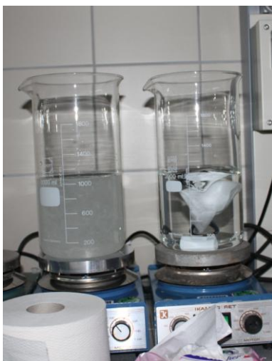
Auch nach 24h tut sich beim Feuchttuch (r) im Rührversuch wenig, das Toilettenpapier (l) ist nur noch zu erahnen
