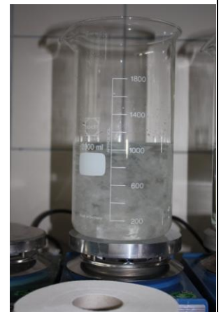
Rührversuch im ZL: Toilettenpapier wird nach wenigen Sekunden Rühren zum Faserbrei
