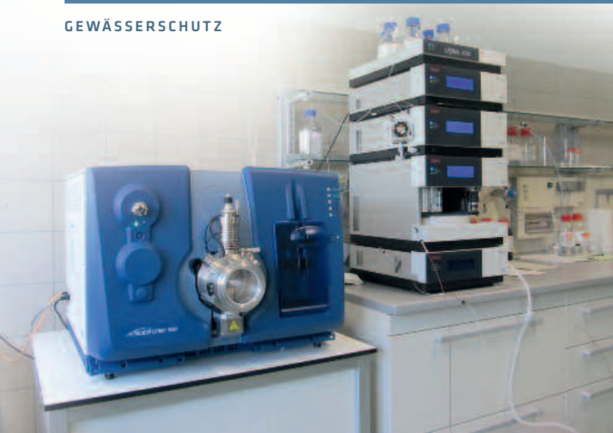
Flüssigkeits-Chromatograph mit Triplequadrupol-Massenspektrometer für die Analyse organischer Spurenstoffe
