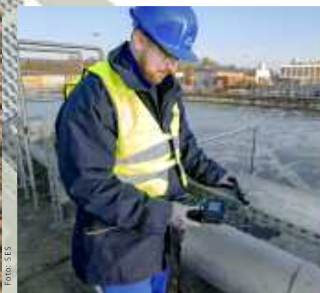
Überprüfung des CSB-Wertes
