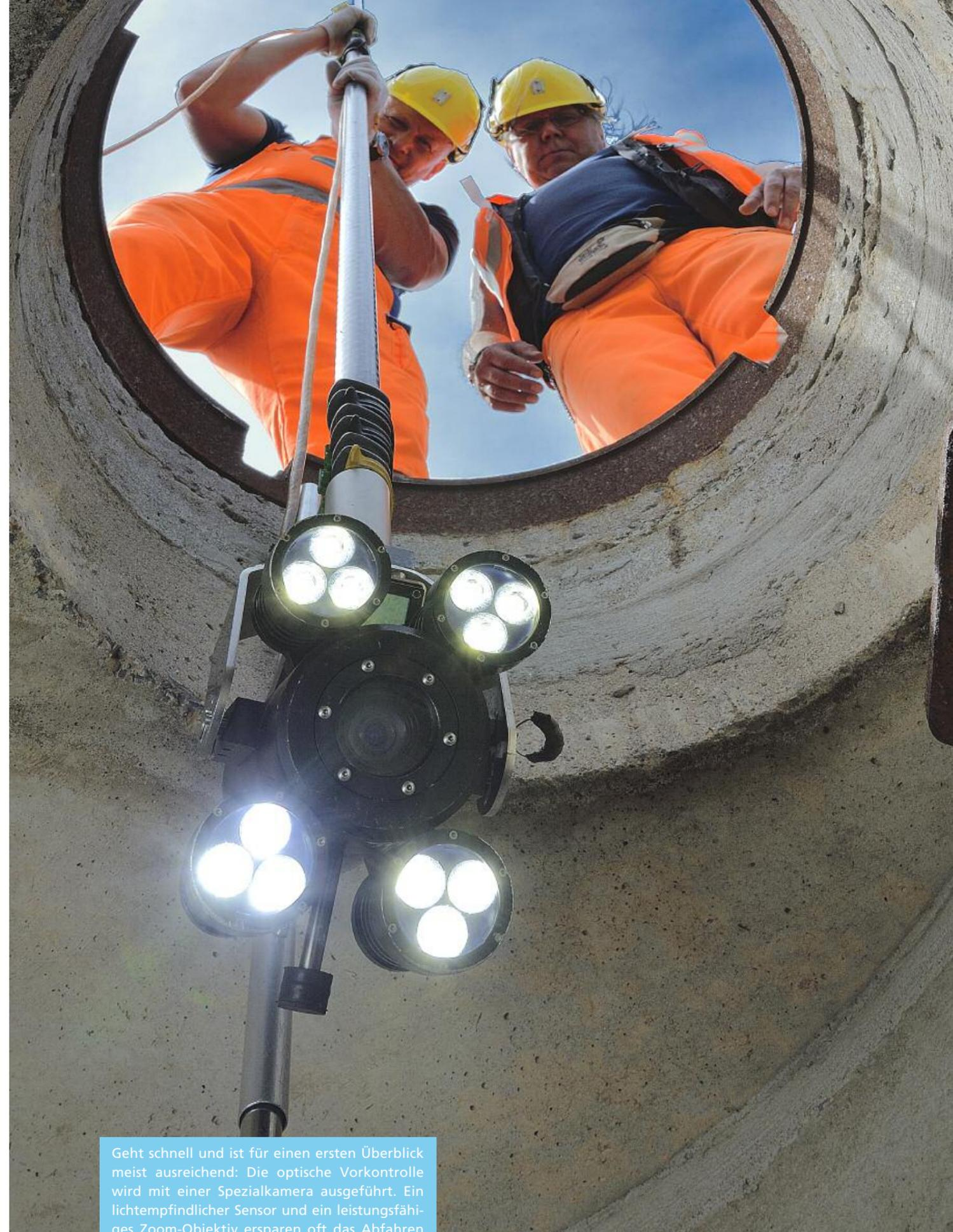
Geht schnell und ist für einen ersten Überblick meist ausreichend: Die optische Vorkontrolle wird mit einer Spezialkamera ausgeführt. Ein lichtempfindlicher Sensor und ein leistungsfähiges Zoom-Objektiv ersparen oft das Abfahren der Kanäle mit der Kanalkamera.
