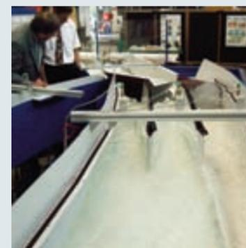
Laborversuch mit dem Modell des Regenauslasskanals des RÜB Schwanenplatz an der Universität Stuttgart
