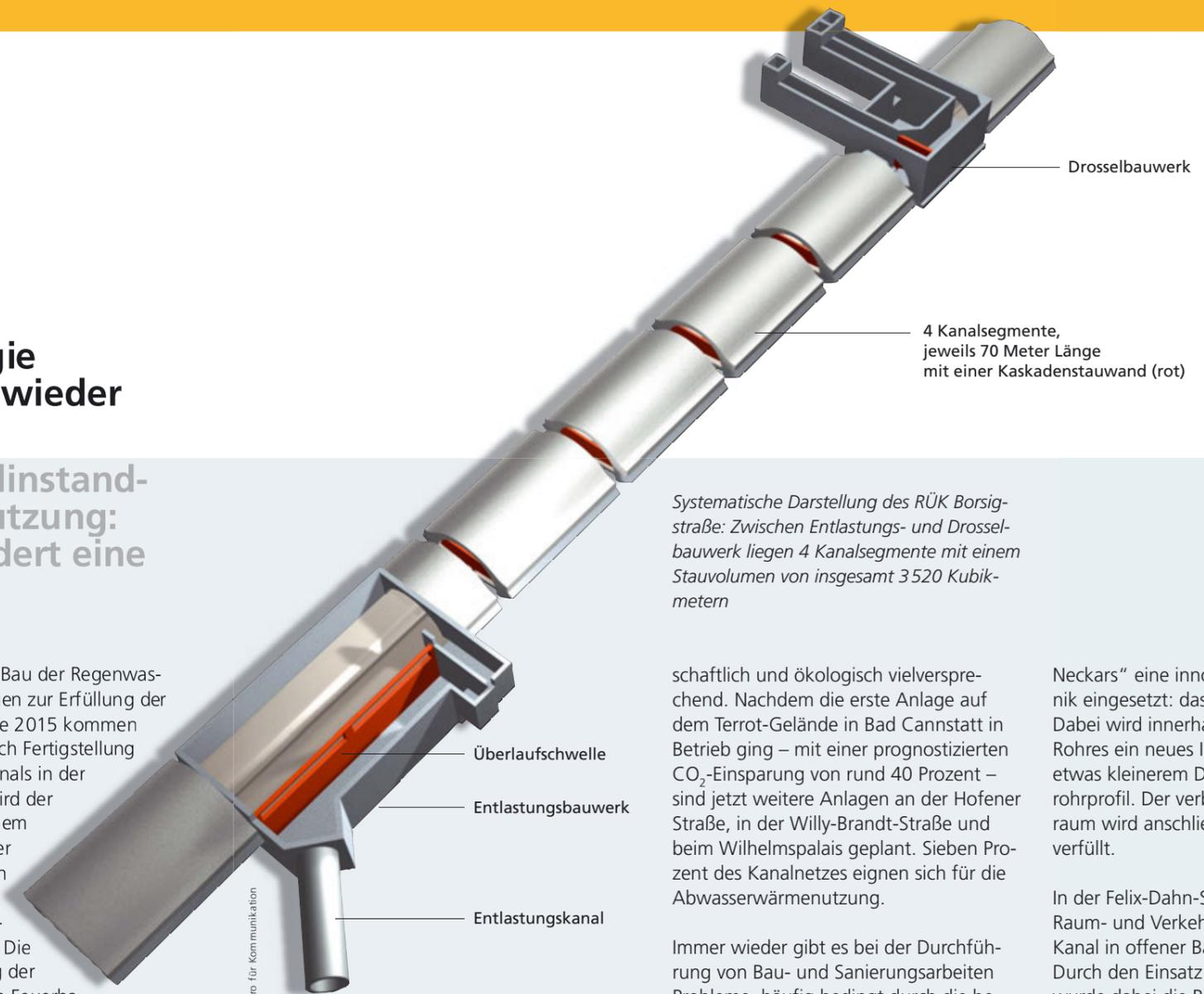
Systematische Darstellung des RÜK Borsigstraße: Zwischen Entlastungs- und Drosselbauwerk liegen 4 Kanalsegmente mit einem Stauvolumen von insgesamt 3520 Kubikmetern
