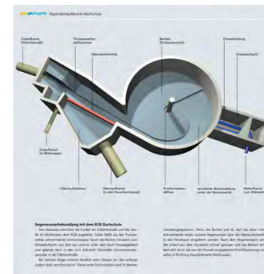
RÜB Bachschule: Wie das Regenüberlaufbecken funktioniert
