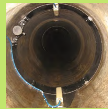
Messvorrichtung für die Durchflussberechnung, zum Beispiel bei der Abwasserwärmenutzung
