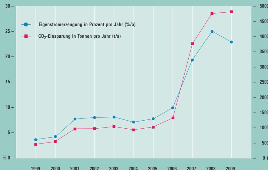
Für eine moderne und umweltbewusste Energiegewinnung wurde von der SES Ende 2007 die europaweit erste, mit Klärgas betriebene Brennstoffzelle im Außenklärwerk Möhringen in Betrieb genommen. Nach einem einjährigen Probetrieb lieferte die Brennstoffzelle 2008 bereits eine Strommenge von rund 1.000 kWh. Mit der Brennstoffzelle sowie den drei Blockheizkraftwerken war es im Jahr 2009 möglich, ca. 43 % des für das Außenklärwerk Möhringen benötigten Stroms selbst zu erzeugen.
