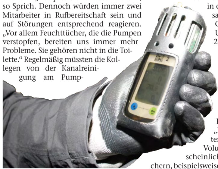
Das Luftmessgerät warnt vor Methan und Kohlenstoffdioxid.
