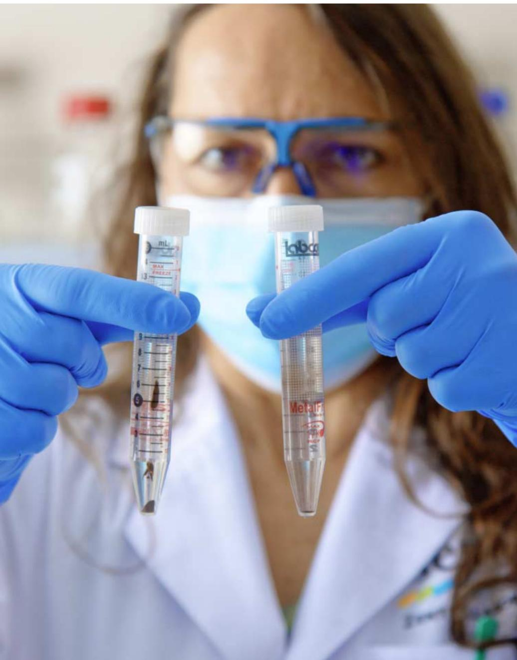
*Nach dem ersten Aufbereitungsschritt einer Abwasserprobe: Die SARS COV2-RNA wurde auf der Oberfläche von winzig kleinen Magnetkügelchen angelagert. Mehrere Reinigungsschritte werden benötigt, bis mit einer PCR-Reaktion die Virenbelastung ermittelt werden kann.*
