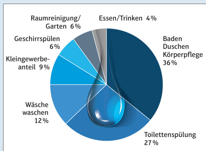
Durchschnittliche Verwendung von Trinkwasser im Haushalt laut Bundesverband der Energie- und Wasserwirtschaft. Grafik: LHS
